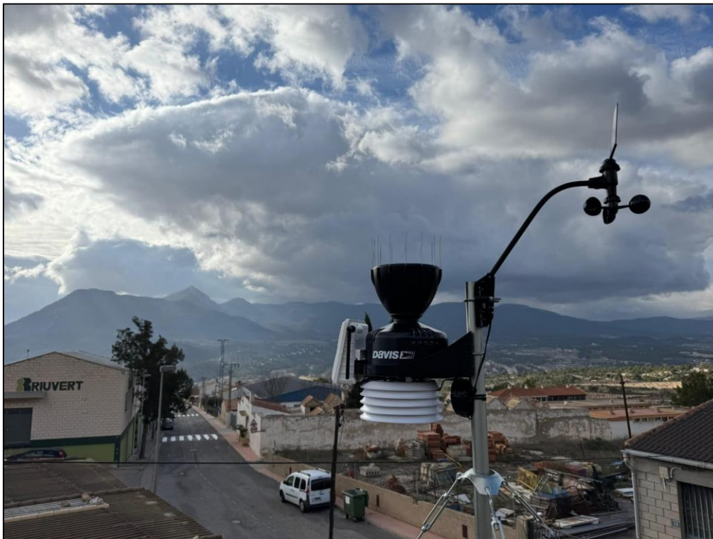
Figura 1. Estación meteorológica Davis Vantage Pro2 de Tibi - Pou Vell.
